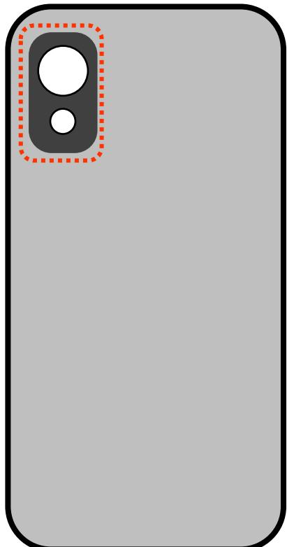
一般的に、画面と反対側に搭載されたカメラを「背面カメラ」と呼びます。
